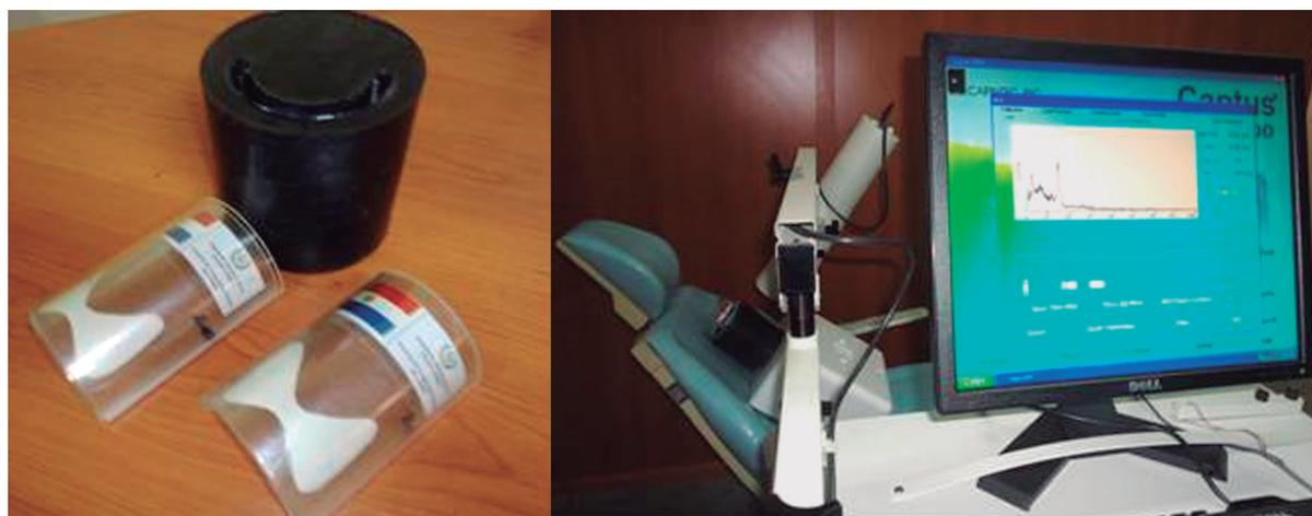
Figura 5. Calibración con Fuente de Ba<sup>133</sup>.
