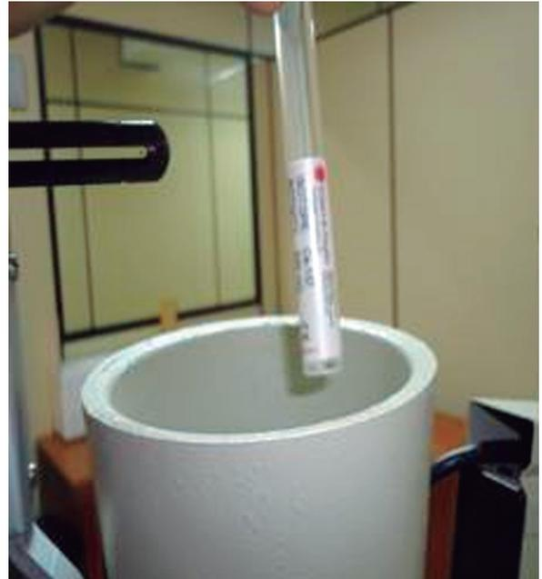
Figura 3. Fuente de Cesio 137 en el detector.
