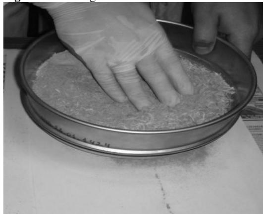
**Fig. 5.** Tamizado de corteza vegetal
