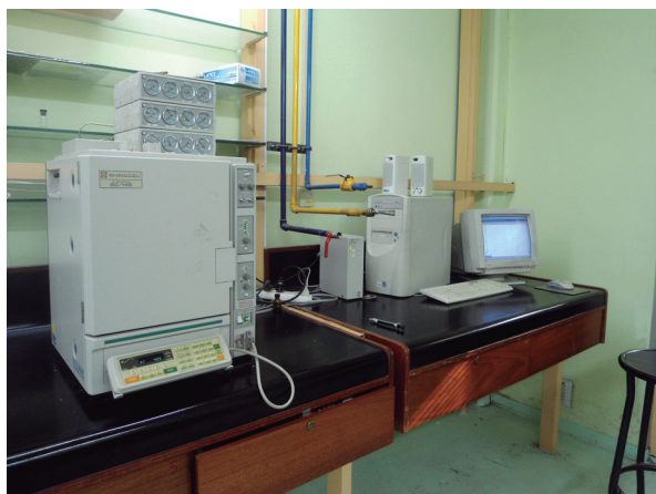
Figura 4. Cromatógrafo de gases "Shimadzu" utilizado para los experimentos cinéticos.
