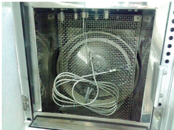
Figura 3. Columna Empaquetada "Porapak Q"
