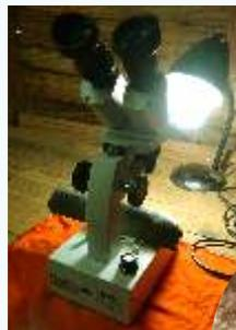
ESTUDIO DE LA MUESTRA A TRAVÉS DEL MICROSCOPIO PETROGRÁFICO, EN EL LABORATORIO.
