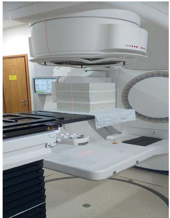
**Figura 5.** Columna de 30 cm de agua sólida centrada con el haz.
