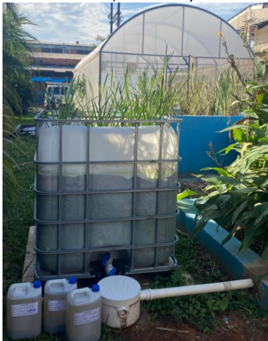
Figura. 1. Humedal subsuperficial de flujo vertical montado.
