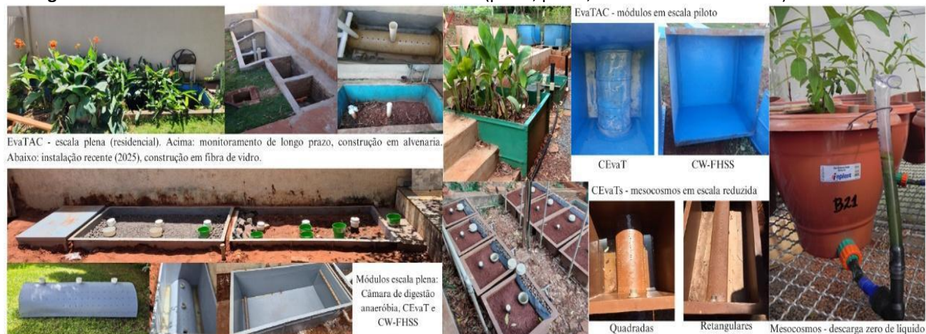
Figura 2. Diferentes escalas estudiadas do sistema EvaTAC (plena, piloto, reducida e mesocosmos).
