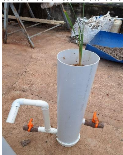
Figura 2. Construcción de humedal vertical de fondo saturado.
